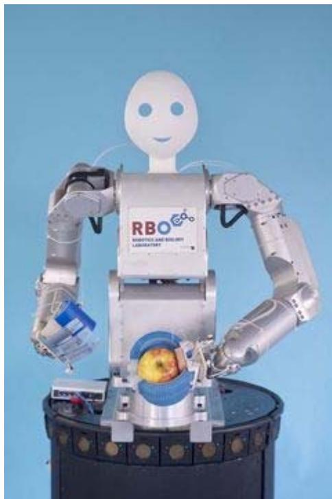
Roboter-Hände sind nicht mehr länger aus Metall, sondern aus weichem Silikon
